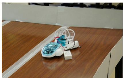
燃料を燃やして熱エネルギーを取り出すのではなく、燃料が酸化される化学変化から電気エネルギーを取り出す仕組みを燃料電池といいます。安全な水の電気分解の体験、発生した水素と酸素を用いた燃料電池による発電、そしてその電池で動くモデルカー見てもらいました。さらに光エネルギーの利用についても考えました。
