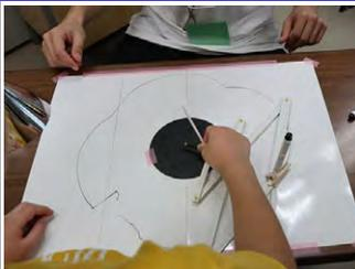
円筒状の鏡に映る像を、「Peaucellierの反転器」という作図器を用いて描いてみる実験をしました。物体と像と円筒の半径の間には「反転」の関係が成り立っており、その関係のもとで反転器は動きます。最後には、反転器で歪んだ絵を描き、それが円筒状の鏡に映ると元の形に戻る実験もしました。
