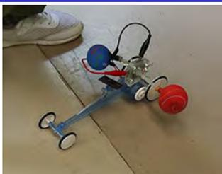
料電池を題材とした手ごろで簡単な実験を通して科学に触れる機会を持ちました。燃料が燃えるときにエネルギーを電気として取り出すことができる仕組みを燃料電池と呼びます。ここでは、燃料電池で車の模型を動かす等、燃料電池に関わる実験を通し、現象や原理について理解を深める展示を行いました。
