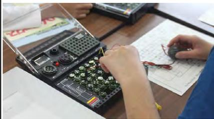
半田付けしないで電子ブロックを使いワイヤレスマイクを組み立てました。完成したワイヤレスマイクを動作させ電線が繋がっていないのに離れた所にあるラジオからマイクの声が聞こえました。これは電波を使って送られてきたことが分かりました。同時に2台を動作させると混信してマイクの声が良く聞こえなかった、リビート音になりすることも体験しました。
