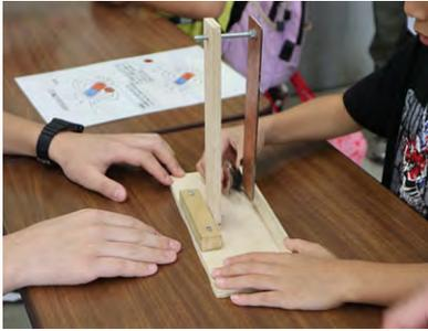
非磁性体であっても、導電性であれば磁石を動かすことで生じた誘導電流で磁界を生じ、磁石に追従するような動きをさせられること（交流モーターの原理）を示した。また、圧電効果や導電体相互間の静電容量等についても紹介しました。
